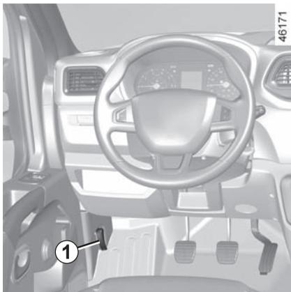
Zum Öffnen am Hebel **1** ziehen.
