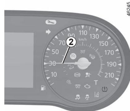
Tachometer 2 (Anzeige in km/h oder mph)
