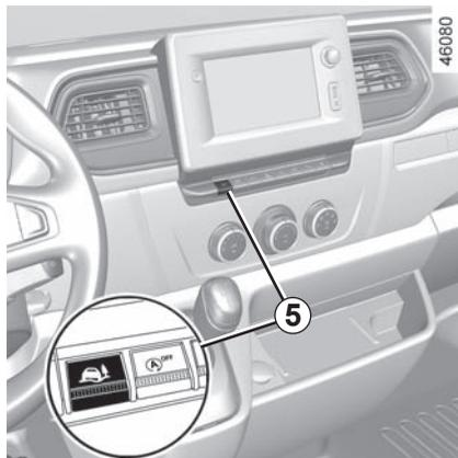
Drücken Sie den Schalter **5**: Die Meldung „Mod.weich.Boden aktiviert“ wird in der Instrumententafel angezeigt.
