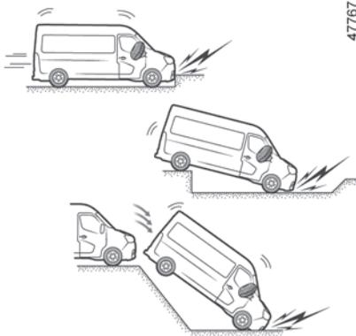
In den folgenden Beispielen werden die Gurtstraffer und die Airbags möglicherweise ausgelöst:
